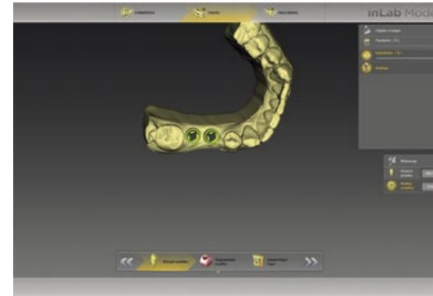
In der darauf folgenden Designphase werden alle herausnehmbaren Bestandteile des Modells geplant. Im hier gezeigten Fall zählten dazu sowohl die Modellanaloge (DIM, NT Trading) ...
