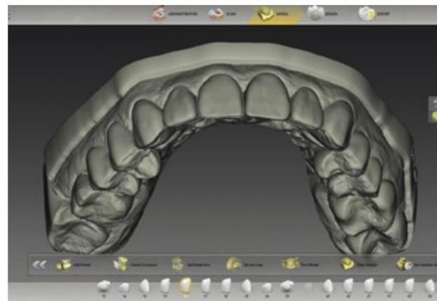
Der nächste Prozessschritt umfasst die Bearbeitung der Kopierlinien und ist wichtige Voraussetzung für den BioCopy-Erstvorschlag. Jeder Einzelzahn wird angeklickt und die Software schlägt jeweils eine Kopierlinie vor, die bei Bedarf manuell geändert werden kann.
