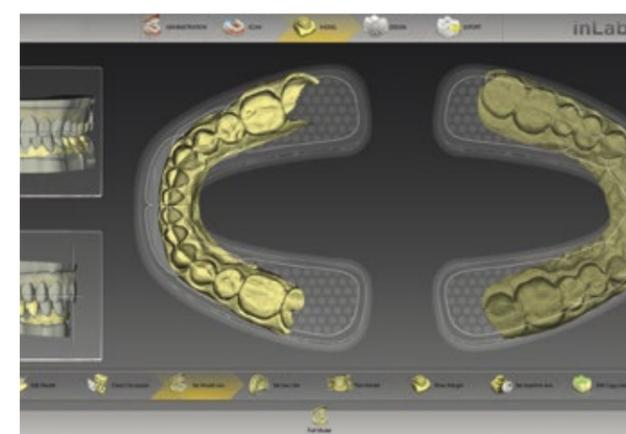
Um der Software die bestmögliche Datenbasis als Ausgangspunkt für einen Erstvorschlag zu geben, wird zunächst die Modellachse ausgerichtet.
