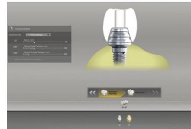
Um eine gute Verbindung zwischen der Brücke und den adhäsiven Titankappen zu erreichen, ist es wichtig, die Restaurationsparameter wie Spacer sowie Mindest-(wand)stärke radial und okklusal anzugeben.
