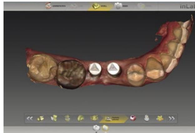
Zu Erfassung der korrekten Implantatposition werden die Spitzen der erfassten Scanbodies mit je einem Doppelklick exakt ausgewählt, bevor sich das Restaura-tionsdesign anschließt.
