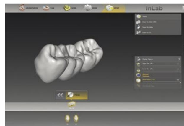
Danach ist die Restauration bereit für den Export. In diesem Fall wurde die Fräseinheit inLab MC X5 (Dentsply Sirona) eingesetzt. Der Fall kann auch im STL-Format exportiert werden, falls man eine andere offene Fertigungseinheit nutzen möchte.
