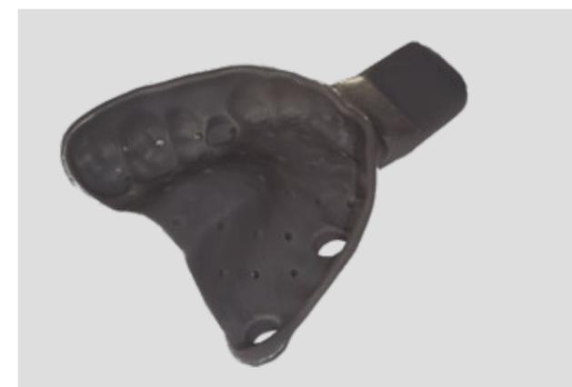
Das mit der inLab CAD SW erstellte Design wurde mithilfe eines 3D-Druckers umgesetzt.
