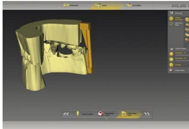
Bei Bedarf können mit der inLab Model Anwendung zweiteilige Stützstrukturen erstellt werden. Im vorliegenden Fall war zwar eine ausreichende dentale Abstützung vorhanden, zu Anschauungszwecken wurde jedoch trotzdem eine entsprechende Stützstruktur eingefügt (orange).
