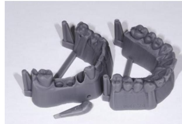
Das geprintete Modell mit herausnehmbarem Stumpf, Implantatanalog und Gingivamaske.
