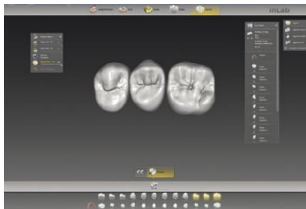
Bevor die Konstruktion in die inLab CAM Software exportiert wird, ist eine letzte Überarbeitung in der Phase „Export“ der Software möglich. Hier sind die drei Brücken dargestellt, die später aus Komposit gefräst und ...
