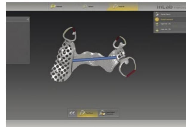
Vor der Übergabe an den 3D-Drucker ist es nun noch notwendig, eine Support-Röhre (blau) als Stabilisierungsstrebe einzuziehen. Auch die Klammern erhalten in diesem Schritt noch zusätzliche Stützen für den Druck (rot). Diese Konstruktion kann nun problemlos gedruckt, angestiftet und gegossen werden.
