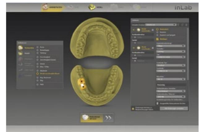
Im Administrationsbereich der inLab CAD Software (hier Version 18.0) wird der Auftrag zunächst mit wenigen Klicks den Vorgaben des Behandlers entsprechend angelegt: Durch Aktivierung des Kontrollkästchens „Multilayer“ können Krone und Abutment dabei später in einem Arbeitsgang hergestellt werden.
