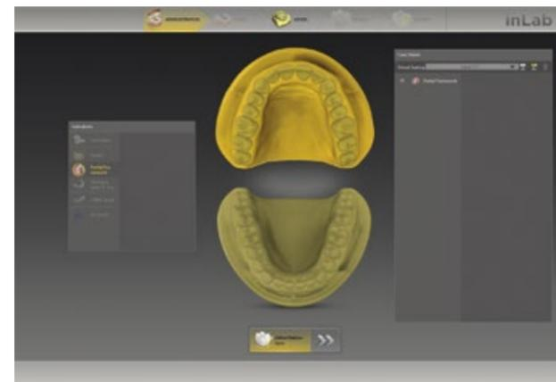
Der digitale Auftrag wird über das Sirona Connect Portal in der inLab CAD SW empfangen, geprüft und angenommen. Im Administrationsbereich erfolgt danach die Angabe der Konstruktionsart „Modellguss“.
