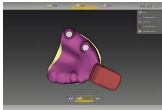
Im nächsten Schritt zeigt die Software den fertig konstruierten Löffel – hier mit den Öffnungen für Abformpfosten an den Implantatpositionen und einem frontal positionierten Griff.
